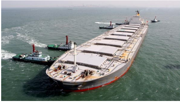
Oil-Bulk-Ore Ships - ნავთობ მადან-მზიდი (ობო-ს ტიპის) გემები (ამერიკული აღნიშვნა OBO = Ore-bulk-oil )
