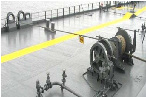
გემბანის სამისაბმელო რგოლზე ავტომატური ჯალამბარი
